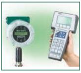
Les débitmètres multi variable Pro-V™de Vortek instruments combinent 3 éléments primaires de mesure : un capteur Vortex de vitesse, une sonde à résistance pour la température et un capteur de pression, de façon à pouvoir mesurer des débits massique de gaz, liquides et vapeur. Les systèmes qui utilisent des capteurs externes peuvent ne pas compenser parfaitement du fait des variations des conditions de process entre le point de mesure de vitesse et les points
