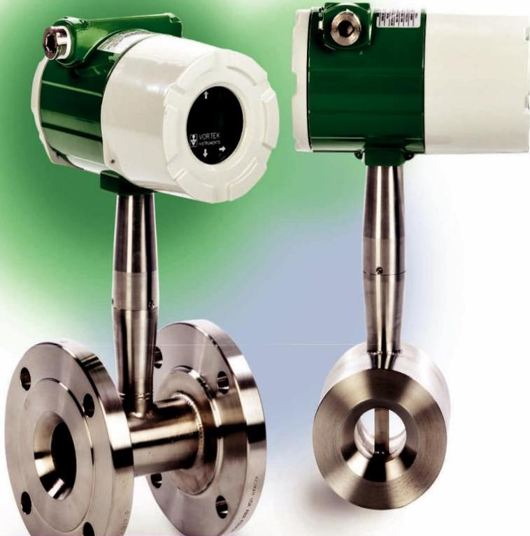
Les débitmètres multivariables Pro-V™ de VorTek Instruments utilisent trois éléments de détection primaires - un capteur de vitesse de déstagement de vortex, un capteur de température RTD et un transducteur de pression à l'état solide - pour mesurer le débit massique de gaz, de liquides et de vapeur.
