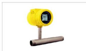
Débitmètre **en ligne de bobines** pour une utilisation dans les tailles de ligne 1", 1 1/2" et 2" [DIN25, DIN40 et DIN50]. La plage d'étalonnage typique va de 0,006 à 838 SCFM [0,01 NCMH à 1425 NCMH].
