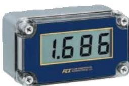
**Le Modèle DM10** est un afficheur LCD qu'il est possible d'insérer et positionner partout dans la boucle de sortie 4-20 mA depuis le ST50. Il ne nécessite aucune alimentation électrique séparée puisqu'il dérive son courant électrique directement depuis la boucle 4-20 mA. Le DM10 est programmable par l'utilisateur jusqu'à  $\pm 1999$  digits et possède des caractères surdimensionnés de 25 mm de hauteur pour une lecture plus aisée. Spécifié NEMA 4X. Modèles certifiés FM et CSA en option.
