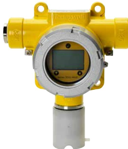
Fournis préconfigurés, les capteurs intelligents intrinsèquement sûrs peuvent être remplacés à chaud sans couper l'alimentation du détecteur, permettant ainsi de gagner du temps et d'économiser de l'argent sur les mises en service et les maintenances de routine. Grâce au kit de montage de capteur déporté, les capteurs peuvent être installés jusqu'à 15 m (50 ft) de l'émetteur : un précieux atout dans les zones difficiles d'accès.
